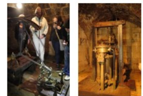
Stollensystem d. Alten Saline Links: Solepumpe. Rechts: Reichenbachsche Solehebemaschine.
