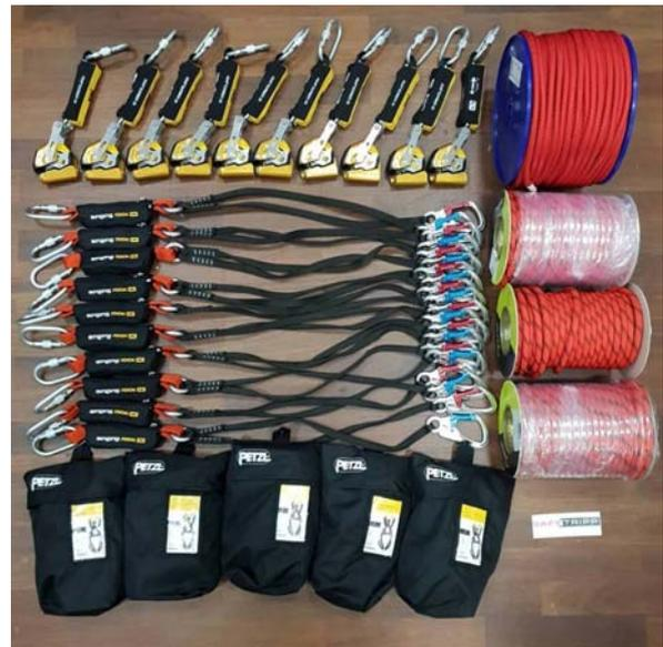
**10 Safetripp Sicherungssets mit Auffanggeräten vom Typ Petzl ASAP Lock und rote Sicherungsseile**
